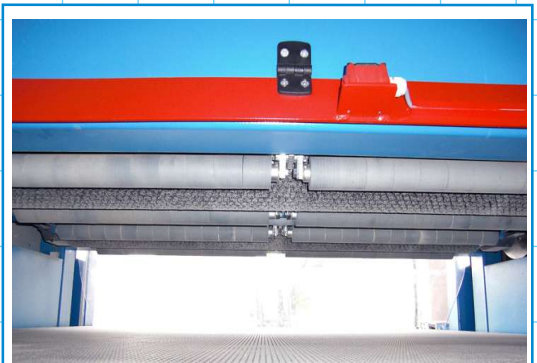
zwei Schleifkornbürsten gegenlaufend
