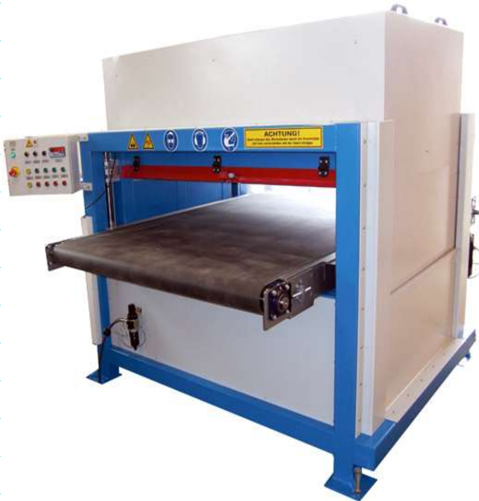
zwei Schleifkornbürsten gegenlaufend
