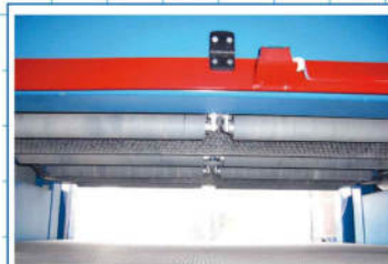
zwei Schleifkornbürsten gegenlaufend
